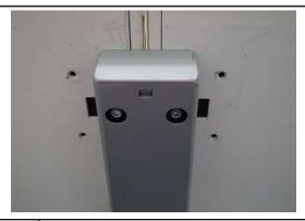
中間脚に連結金具を天板裏面穴に差し込んで、六角穴 付ボルト(M6×1001)・高ナットで天板の目地が揃うように 10 締め込みます。
