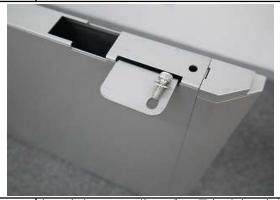
次に天板をフレームに載せてビスで固定します。天板と エンド脚は、M6×15mm キャップスクリューで固定しま す。
