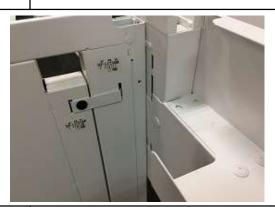
次に片面用梁を中間脚に付けます。同様に梁の端の4 か所の切り欠きに、中間脚のツメを差し込むようにまっ すぐ取付けます。この手順を繰り返し、フレームをつくり ます。
