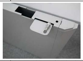
次にフレームに天板をのせて、ビスで固定します。 エンド脚と天板はM6×15 キャップスクリューで仮締めし ます。
