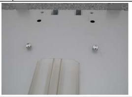
エンド脚の内側のネジ穴の下部2か所にナベ六角ビス M8×20のビスを2、3山取付けます。
