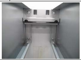
六角ビスM8×20のビスで4か所ビス止めします。もう片 方のエンド脚にも同じように取り付けて、フレーム本体を つくります。中間脚も同様にして、取り付けます。脚のア ジャスターを調整し、レベル出しをしてください。
